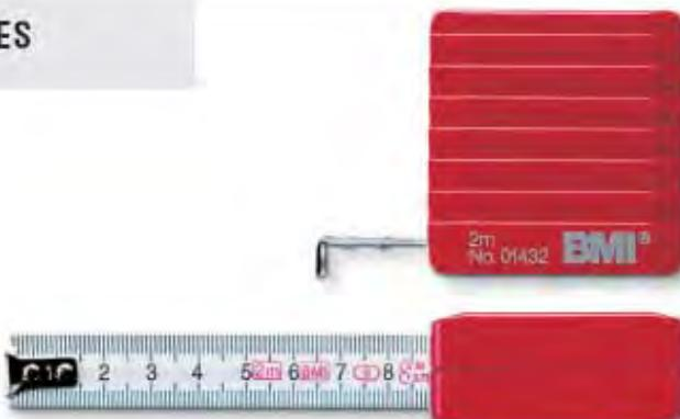
متر جیبی جمع و جور با عملکرد برگشت اتوماتیک متر. قاب ساخته شده از پلاستیک بسیار فشرده ABS طولهای ۲ و ۳ متر با درجه بندی میلیمتری یا میلیمتر / اینچ، پهنهای متر ۱۶ میلیمتر، ابعاد قاب ۲۲×۵۰×۵۲ میلیمتر ۳ متر : ۲۲×۵۵×۵۸ میلیمتر
