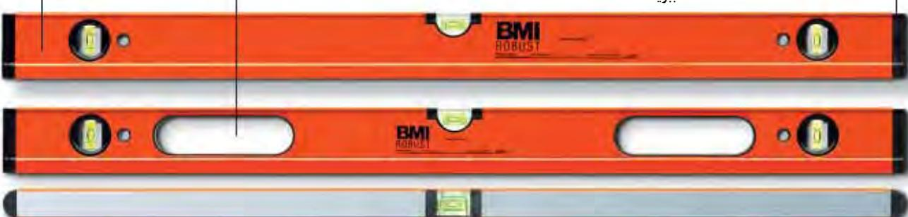
تراز حرفه ای برای بیشتری استفاده، حداقل طول ۱۲۰ سانتیمتر با دو سطح صیقلی برای اندازه گیری مطمئن در دو سمت و در هر موقعیت. ۲ حباب عمودی و یک افقی، پوشش سطح با پودر. کاملاً غیر قابل پیچش به دلیل داشتن پروفیل با چهار اتفاق.
