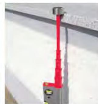
اندازه گرفته شده از طریق پنجره روی این دستگاه قابل مشاهده است. تلوارانس اندازه گیری طبق استاندارد **EC 73/362/EWG**
