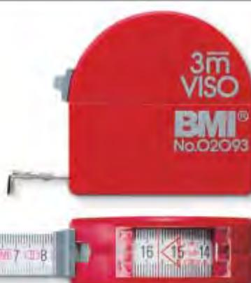
متر اندازه گیری خاص با سه عملکرد: اندازه گیری طول، اندازه گیری سطوح داخلی (رجوع به صفحه ۱۵)، ترسیم دایره. درجه بندی در زیر بخش شیشه‌ای بر عکس نمایش داده نمی‌شود (بدین معنی که هیچگاه در هنگام مشاهده خطراخ نمی‌دهد). دارای قفل تیغه، قاب پلی آمید، حرکت آزاد تیغه در هنگام بیرون کشیدن و جمع کردن متر، طول ۳ متر با درجه بندی میلیمتری یا میلیمتر/اینج. پهنای تیغه ۱۶ میلیمتر، ابعاد قاب ۶۵×۲۵ میلیمتر.
