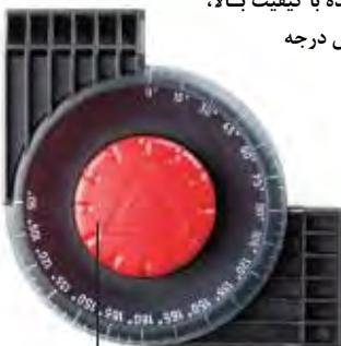
پیچ دستی جهت تنظیم آسان با قفل در هر  $15^{\circ}$  درجه
