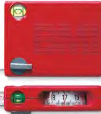
یک متر همه کاره با چهار عملکرد: اندازه گیری طول، اندازه گیری سطوح داخلی (رجوع به صفحه ۱۵)، ترسیم دایره، تراز. درجه بندی در زیر بخش شیشه‌ای بر عکس نمایش داده نمی‌شود (بدین معنی که هیچگاه در هنگام مشاهده خطراخ نمی‌دهد). دارای قفل تیغه، قاب پلی آمید، حرکت آزاد تیغه در هنگام بیرون کشیدن و جمع کردن متر، طول ۳ متر با درجه بندی میلیمتری یا میلیمتر/اینج. پهنای تیغه ۱۳ میلیمتر، ابعاد قاب ۸۰×۲۰ میلیمتر.
