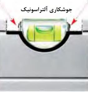
تمامی نرازها (بغیر از نوع  $690$ ) از پروفیل آلومینیمی ساخته شده‌اند و طول آنها حداقل  $120$  سانتیمتر است. حبابها بصورت الکترونیکی تنظیم شده‌اند و با جوشکاری آلتراسونیک در جای خود محکم شده‌اند. حق اختراع این پروسه بصورت ملی و بین‌المللی BMI نسبت شده است.
